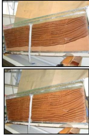
**Figura 3.** Exemplo do processo de infiltração
