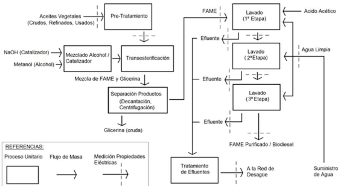
**Figura 1.** Diagrama del proceso de producción de biodiesel.
