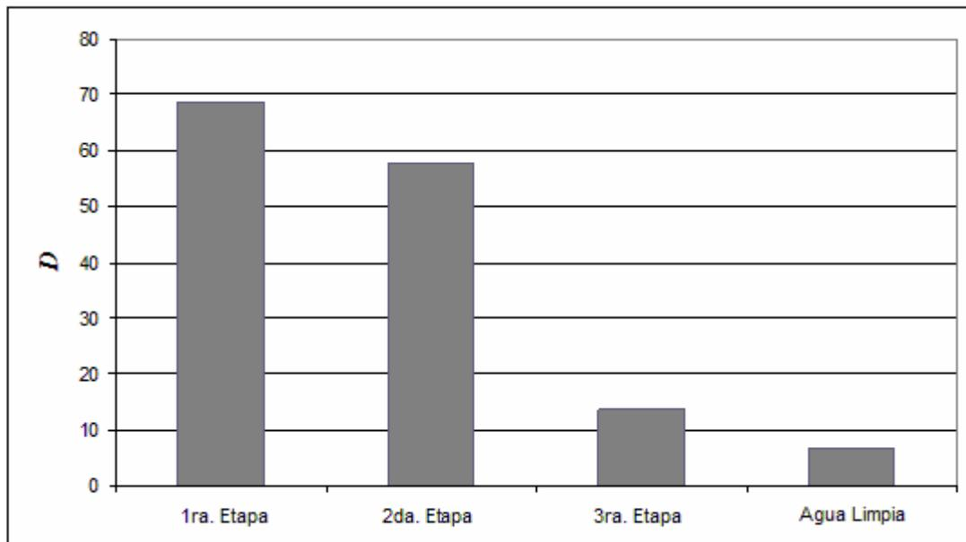
**Figura 5.** Factor de disipación de los efluentes a 25°C y a la frecuencia de 10 KHz para las distintas etapas de lavado.
