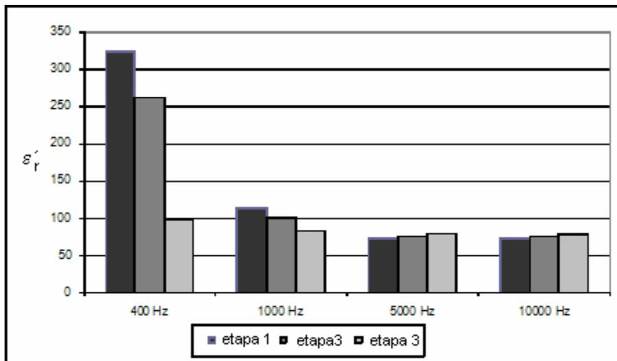
**Figura 3.** Permitividad a  $25^\circ\text{C}$  de los efluentes en función de la frecuencia para las distintas etapas de lavado.
