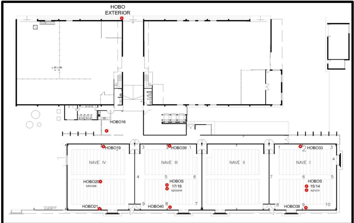
Figura 2: Depósitos organizados en 4 naves. Se indica la posición de los DL y los puntos singulares.
